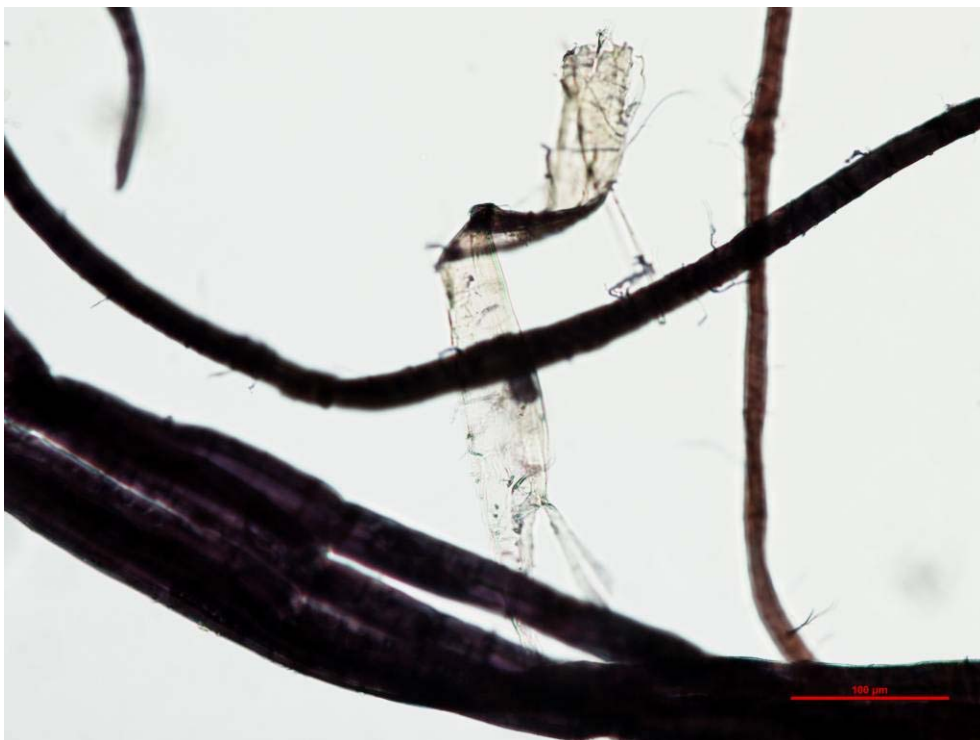
Obr. 2 Vzorek s převažujícími vlákny jehličnanové buničiny, žluté vlákno dřevoviny, vybarveno Herzbergovým roztokem (zvětšeno 200x)
