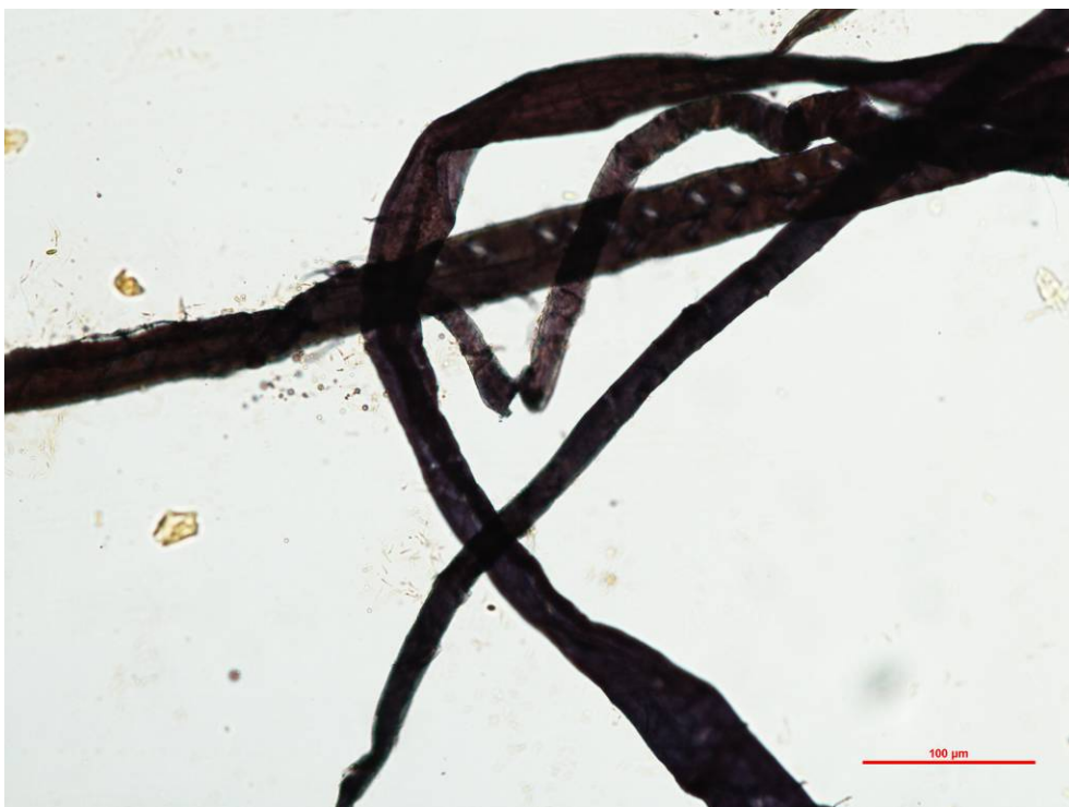
Obr. 1 Vzorek s převažujícími vlákny jehličnanové buničiny, žádná viditelná poškození vybarveno Herzbergovým roztokem (zvětšeno 200x)
