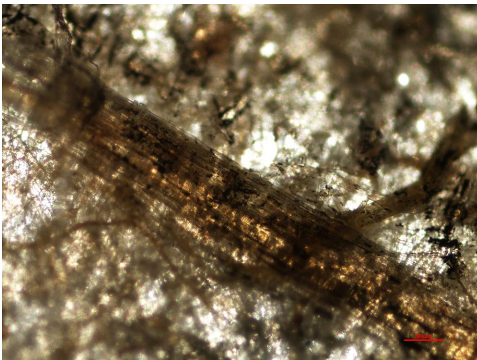
Obr. 5 Vzorek papíru pozorovaný přímo v procházejícím světle mikroskopu, svazek dřevitých vláken (zvětšeno 100x)
