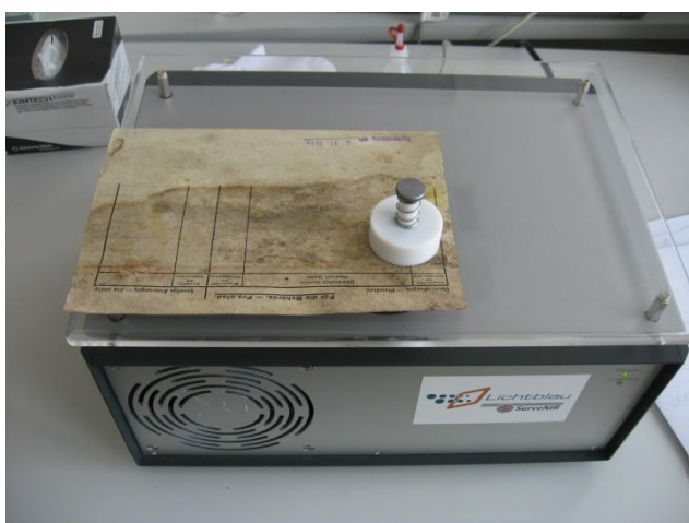
Obr. 2: Pohled na analyzovaný papír při měření NIR spektra
