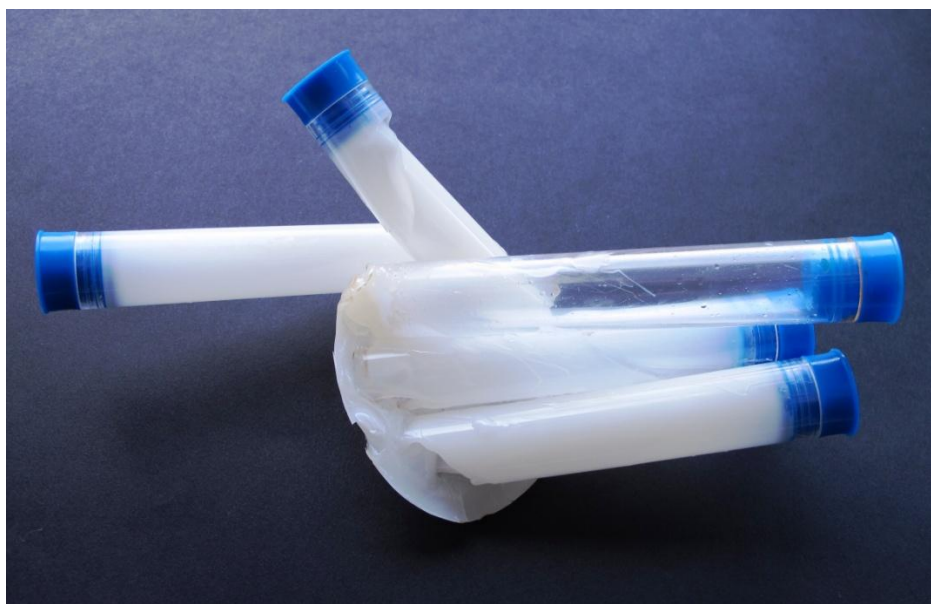
Obr. 2 Polystyrenové zkumavky poškozené vlivem silic
