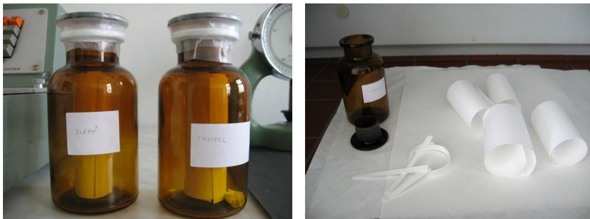
Obr. 1 Umístění vzorků papíru v lahvičkách a odvětrání papíru v digestoři
