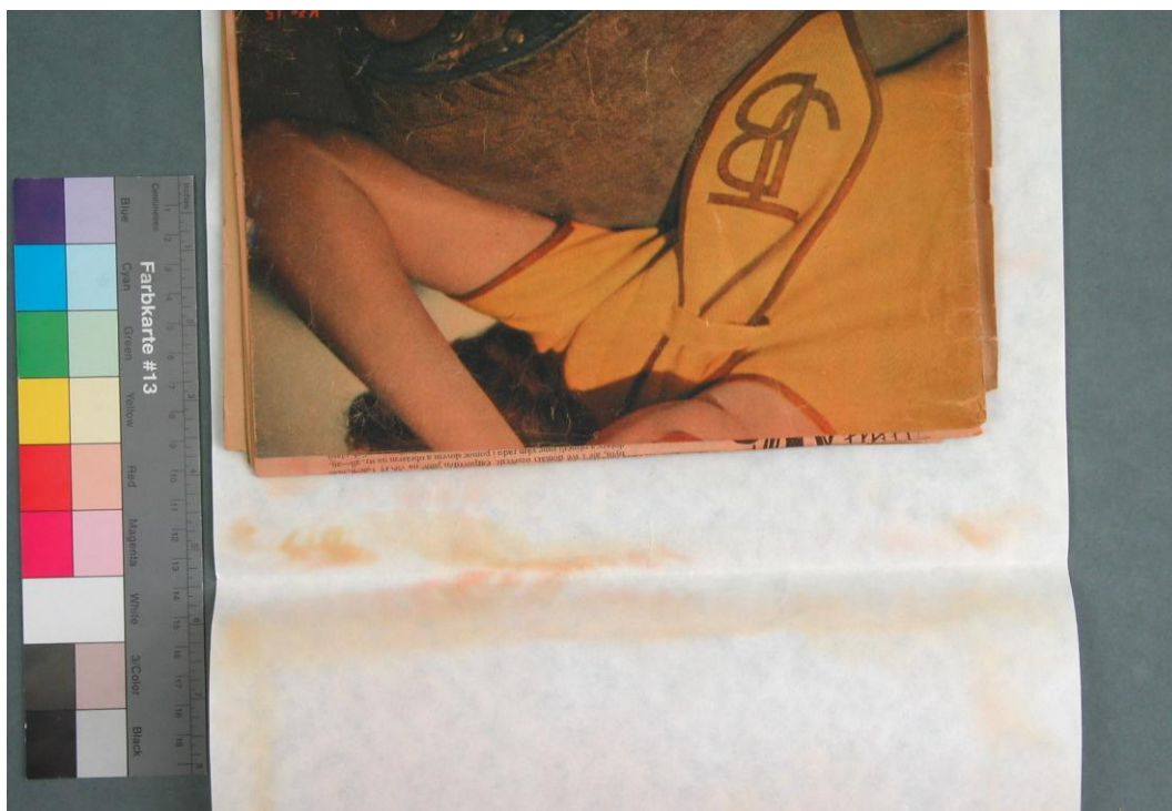
Obr. 9 Vzorek 58 – dřevitý papír, barevný tisk (časopis), rok 1948 (extrahovaná barviva na separačním filtračním papíře).
