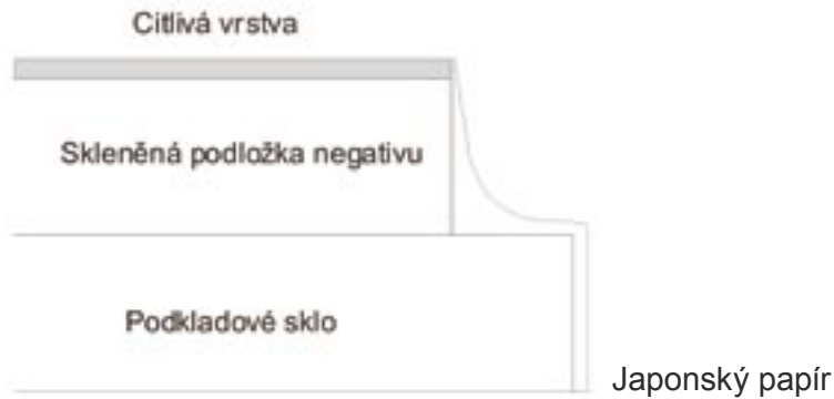
Obr. 25 Schéma spojení negativu s podkladovým sklem pomocí rýžového škrobu a japonského papíru
