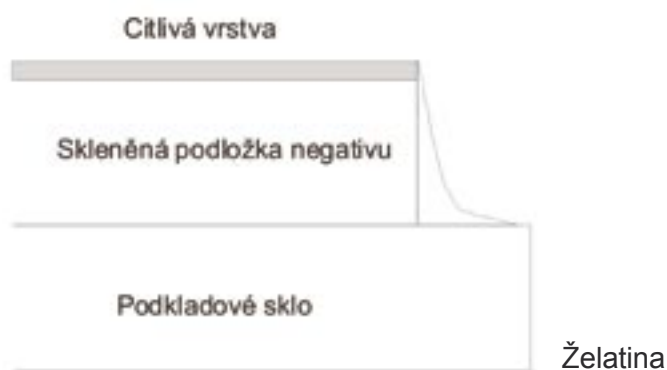
Obr. 24 Schéma spojení negativu s podkladovým sklem pomocí fotografické želatiny
