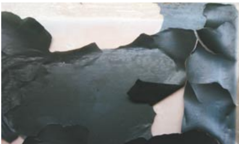
Obr.16 Citlivá vrstva ztrácí adhezí ke skleněné podložce
