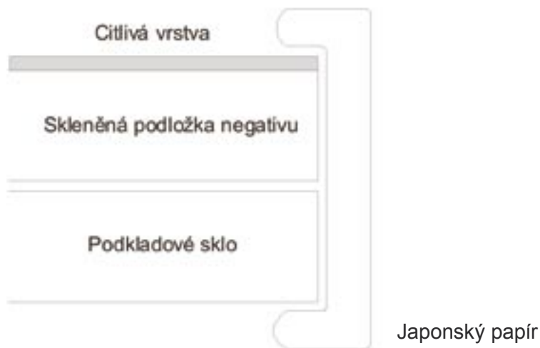
Obr. 22 Schéma přilepení podkladového skla japonským papírem s přesahem do citlivé vrstvy
