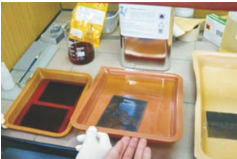
Obr. 7 Promytí negativu etylalkoholem po jeho předešlém ponoření do alkoholového roztoku jódu (typické modrání „zrcátka“)
