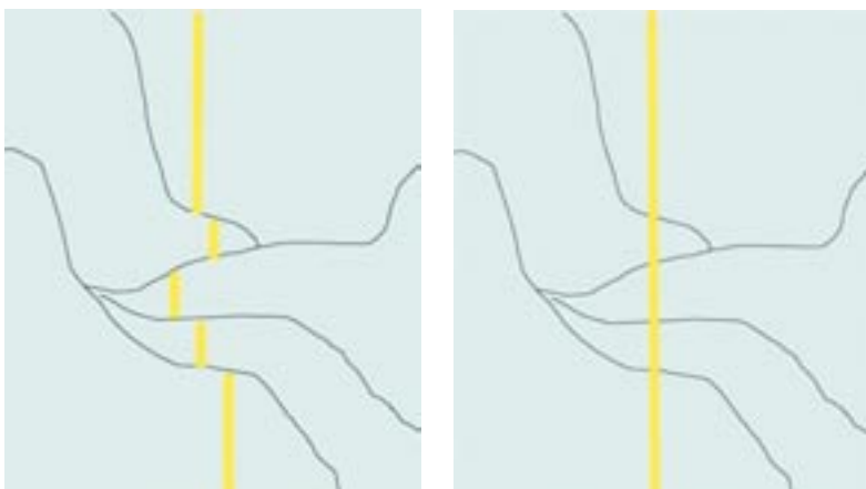
Obr. 14 Kontrola světelnou linkou (vlevo před vyrovnáním, vpravo po vyrovnání)
