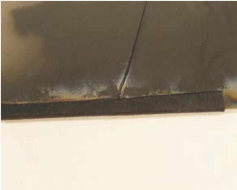
Obr. 21 Oprava rozbitého negativu plátěným proužkem na podkladovém sklu
