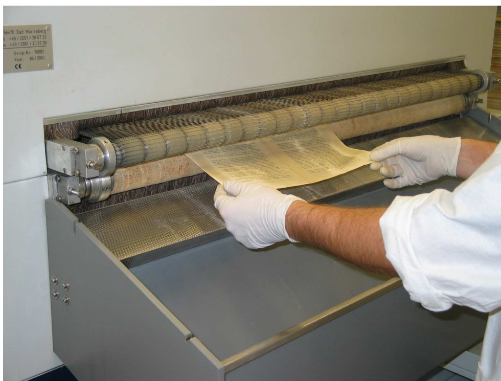
Obr. 4 Průběh odkyselování listových dokumentů na odkyselovacím zařízení C 900 Národní knihovna ve Varšavě
