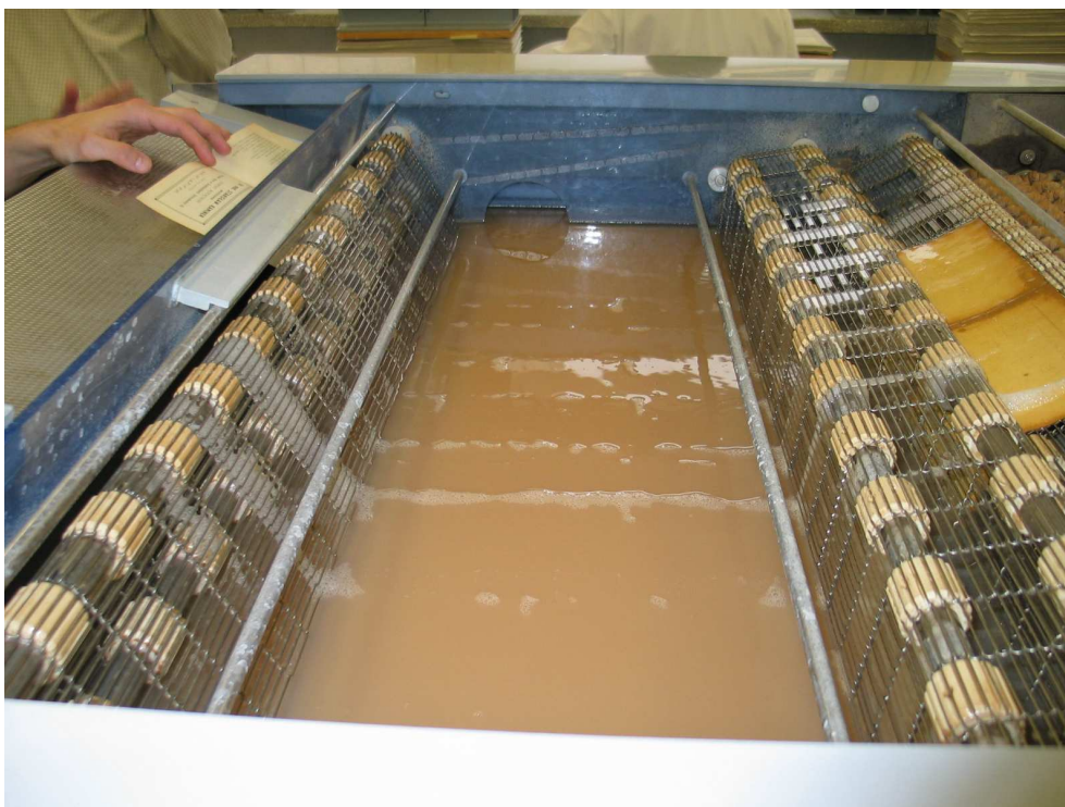
Obr. 2 Průběh odkyselování listových dokumentů na odkyselovacím zařízení C 900 Národní knihovna ve Varšavě
