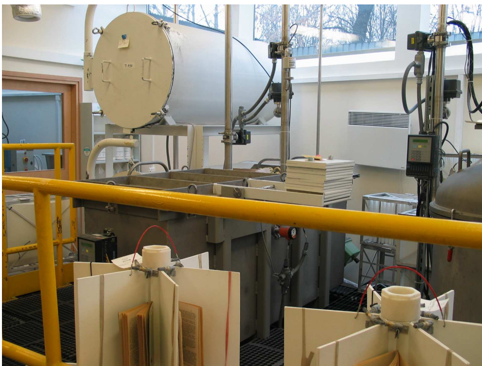
Obr. 10 Horizontální komora odkyselovacího zařízení Bookkeeper pro velké knihy a aktový materiál Jagellonská univerzitní knihovna v Krakově
