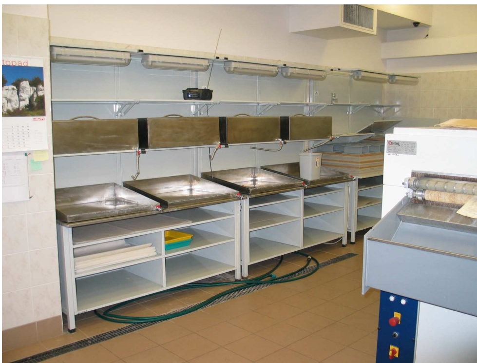
Obr. 6 Nerezové vany pro ruční odkyselování problematických dokumentů Národní knihovna ve Varšavě
