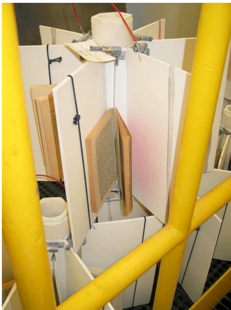
Obr. 15 Stojan pro vertikální odkyselování knih s uchycenými knižními vazbami Jagellonská univerzitní knihovna v Krakově
