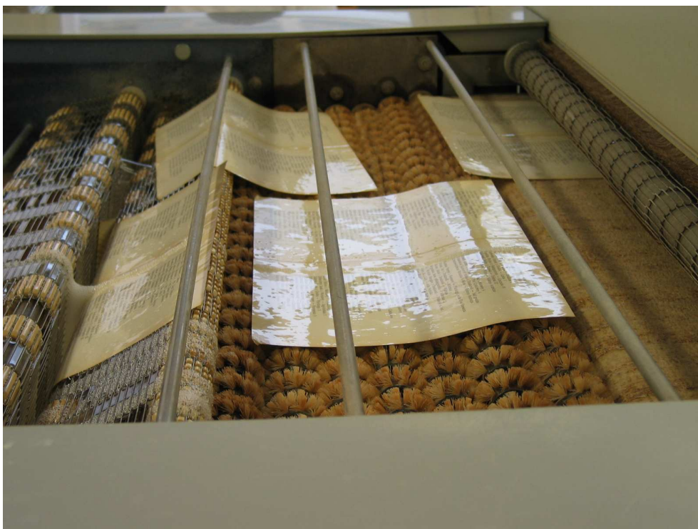
Obr. 3 Průběh odkyselování listových dokumentů na odkyselovacím zařízení C 900 Národní knihovna ve Varšavě
