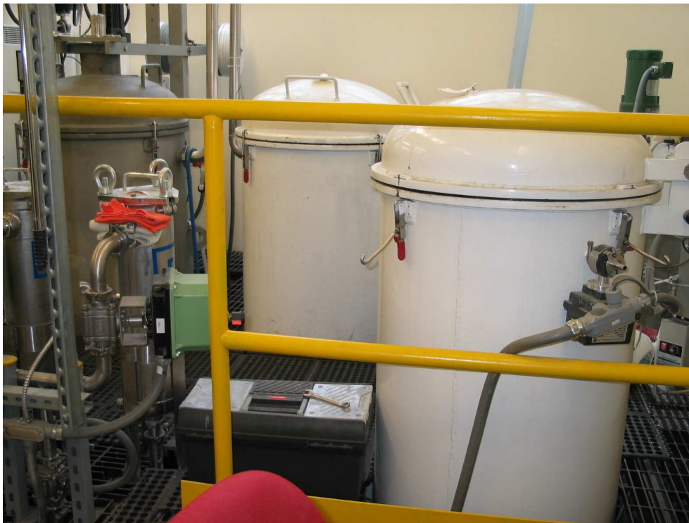
Obr. 13 Vertikální komora odkyselovacího zařízení Bookkeeper pro knihy se dvěma sušicími komorami v popředí Jagellonská univerzitní knihovna v Krakově
