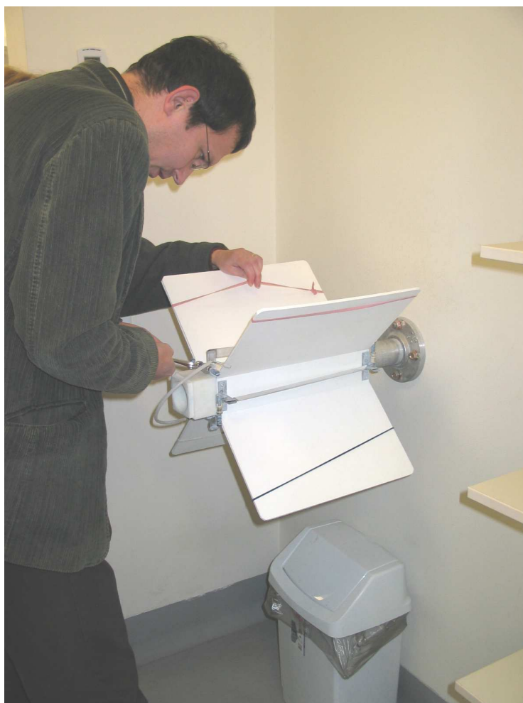
Obr. 14 Stojan pro vertikální odkyselování knih Jagellonská univerzitní knihovna v Krakově
