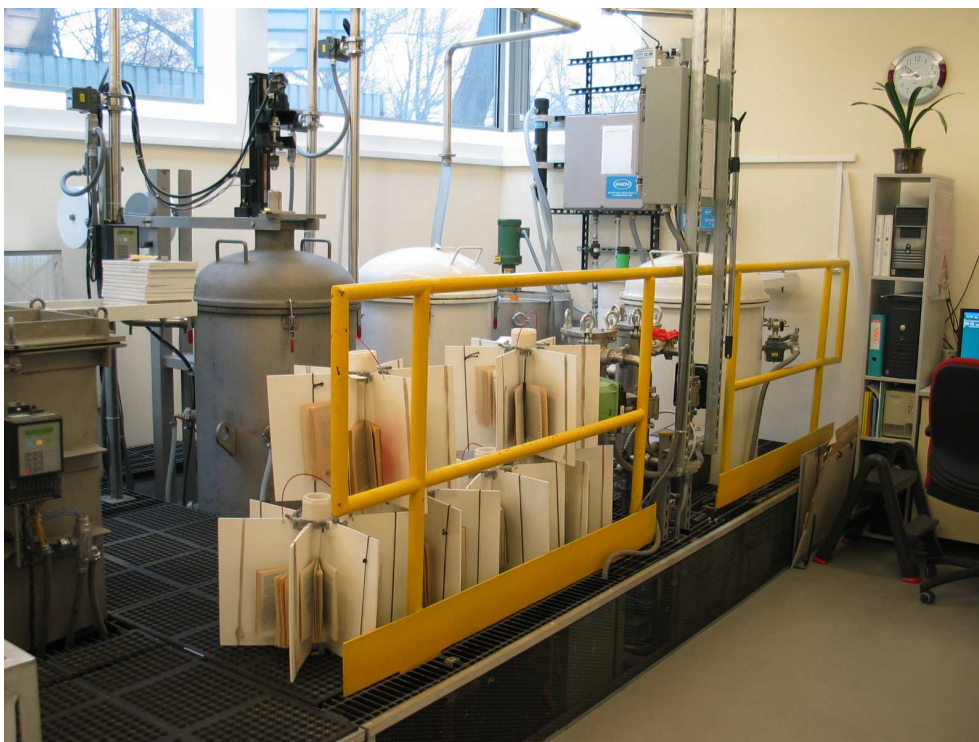
Obr. 9 Zařízení odkyselovacího zařízení Bookkeeper Jagellonská univerzitní knihovna v Krakově
