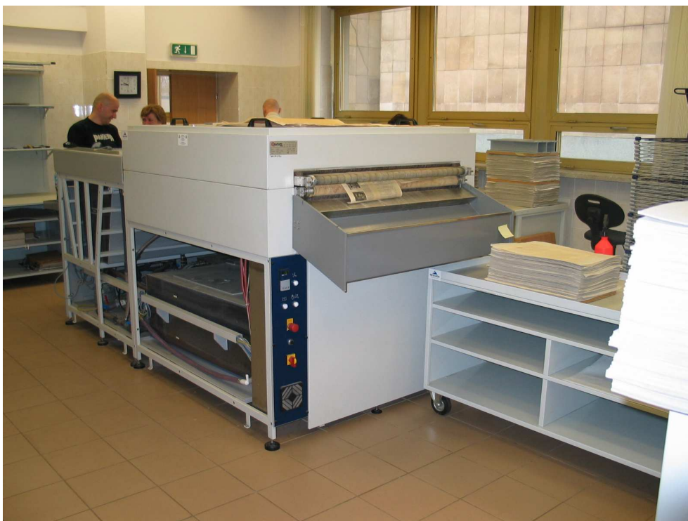
Obr. 1 Odkyselovací zařízení C 900 firmy Neschen Národní knihovna ve Varšavě
