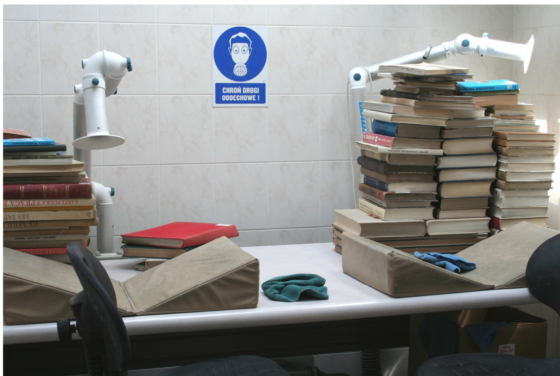
obr.15 Čištění povrchu knih před expedicí od přebytku oxidu hořečnatého
