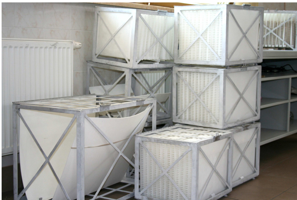
obr.12 Kontejnery pro ukládání aktového nebo velkorozměrového materiálu do horizontální komory
