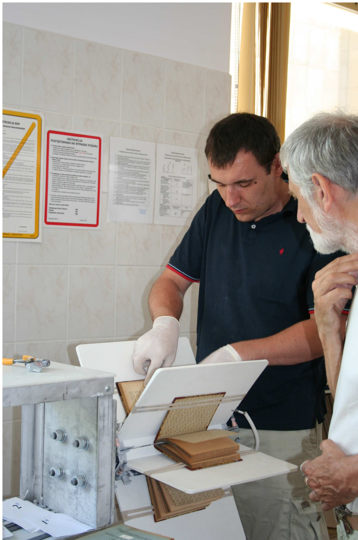
obr.14 Upínání knih přivezených z Národní knihovny za účelem testování účinnosti procesu
