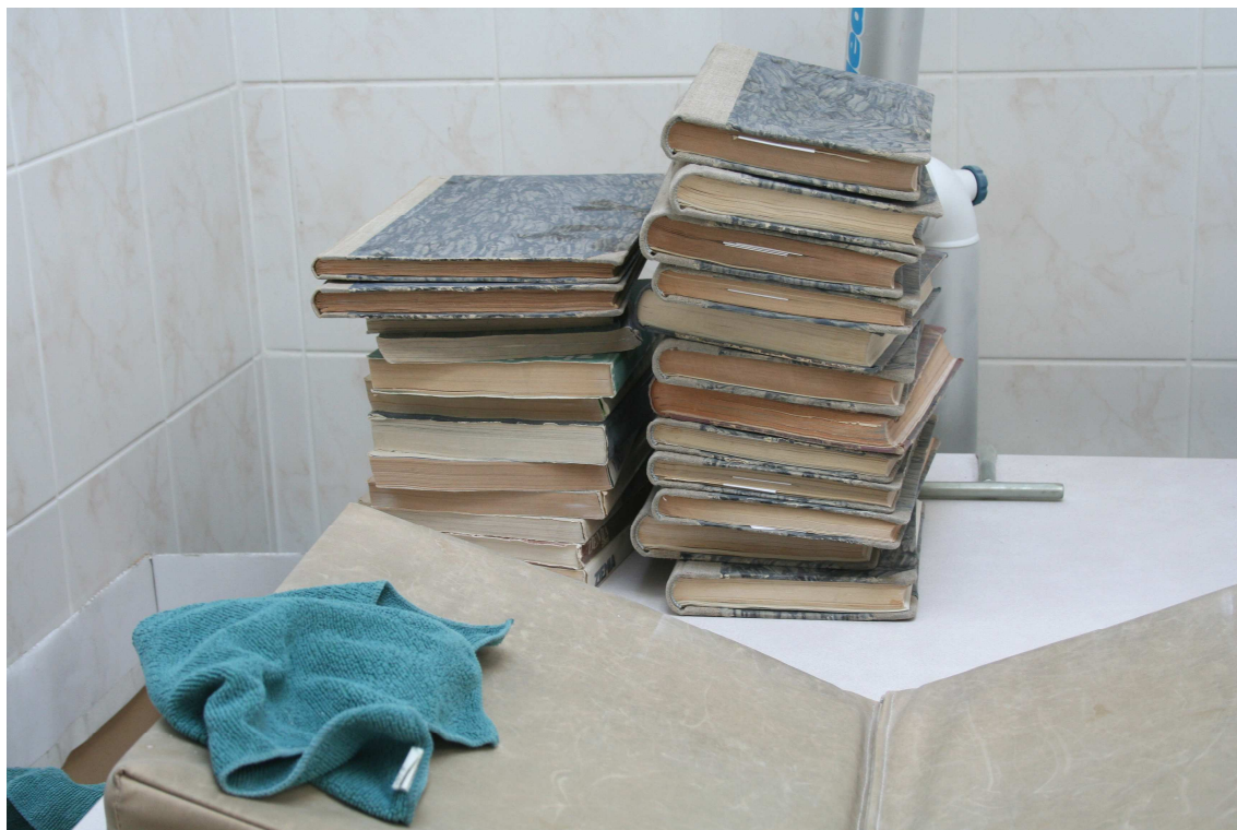
obr.14 Čištění povrchu knih od přebytku oxidu hořečnatého pomocí utěrek z mikrovláken
