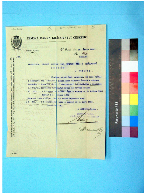
Obr.6 Pravá část odkyselená technologií CSC Book Saver®
