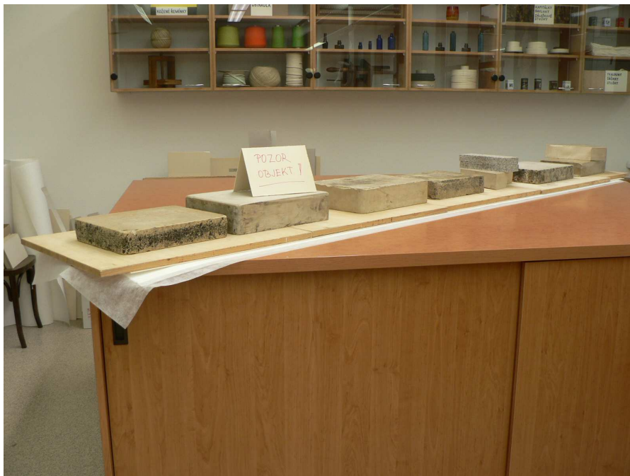
Obr. 17: Vlhčení pomocí membrány Gore-Tex®
