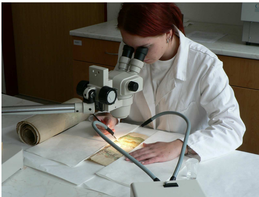
Obr. 9: Lokální zpevnění uvolněné barevné vrstvy 1,5% roztokem Klucelu G v isopropanolu
