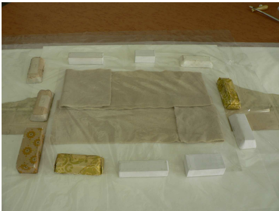
Obr. 17: Vlhčení pomocí membrány Gore-Tex®
