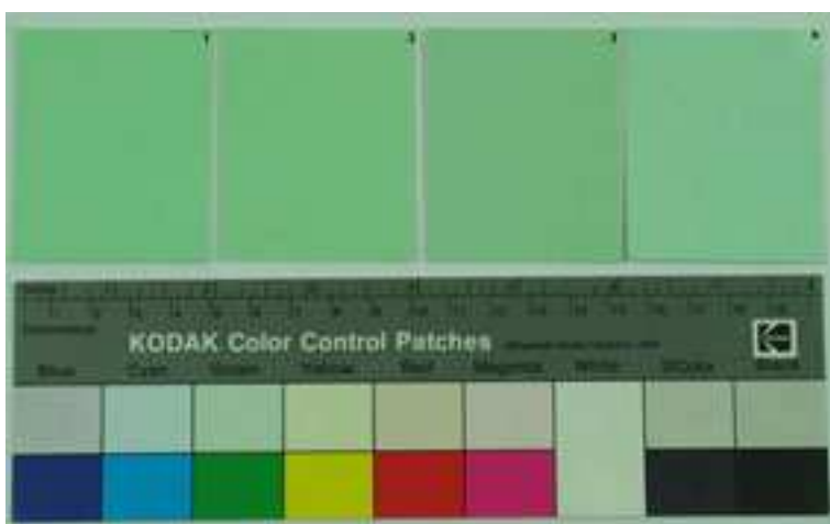
Obrázok 8: Snímka vzorky lepenky NK : 1-nestarnutá; zostarnutá 2-suchým, 3-vlhkým a 4-svetelným starnutím
