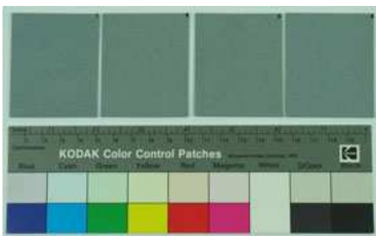
Obrázok 9: Snímka vzorky lepenky Emba Laurent: 1-nestarnutá; zostarnutá 2-suchým, 3-vlhkým a 4-svetelným starnutím
